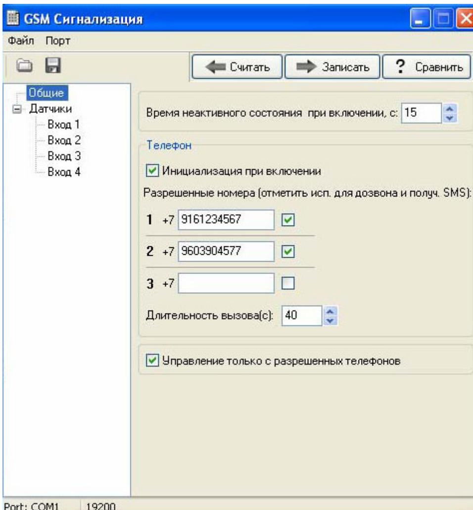
На закладке программы **«Порт»**, нужно указать номер порта, к которому подключено устройство.
